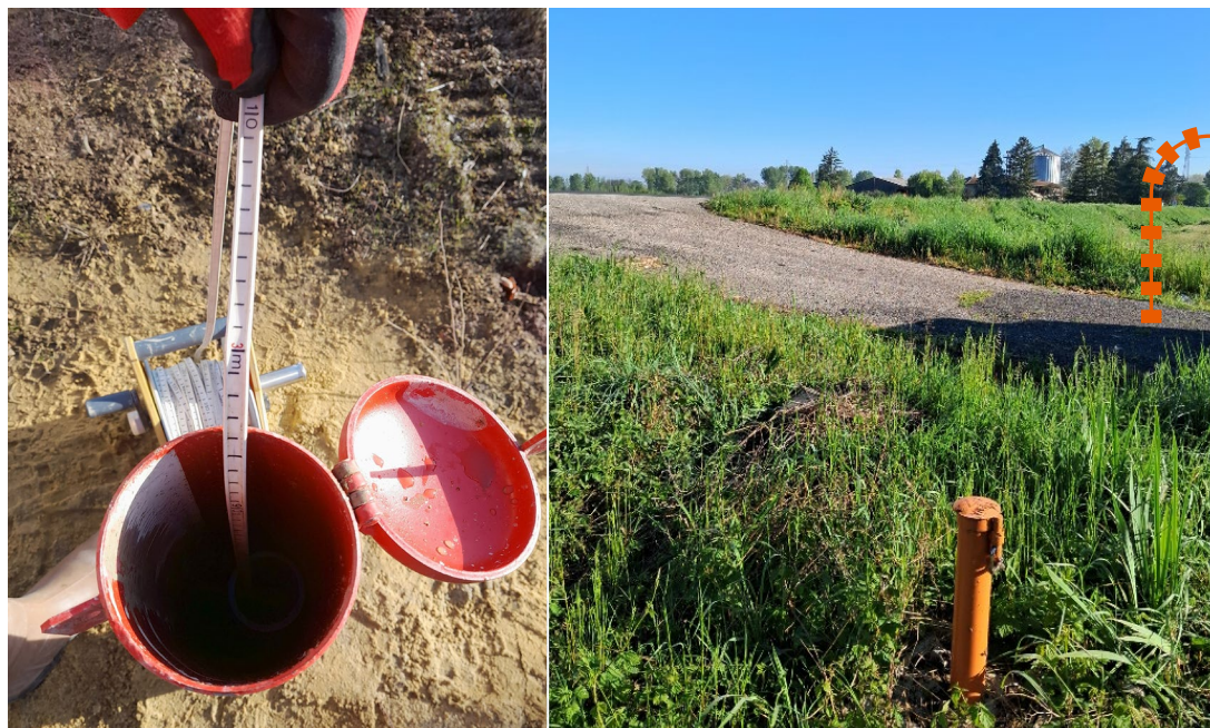
Mesure du niveau de l'eau dans un piézomètre
